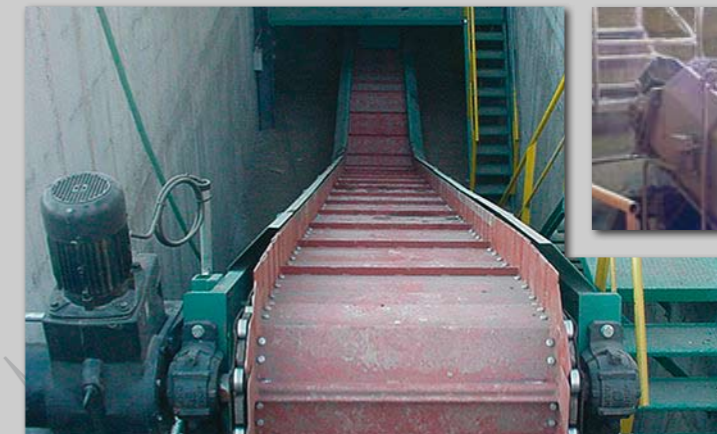
Stållamelbånd transporterer varme letklinker fra rotéovn og køler.
