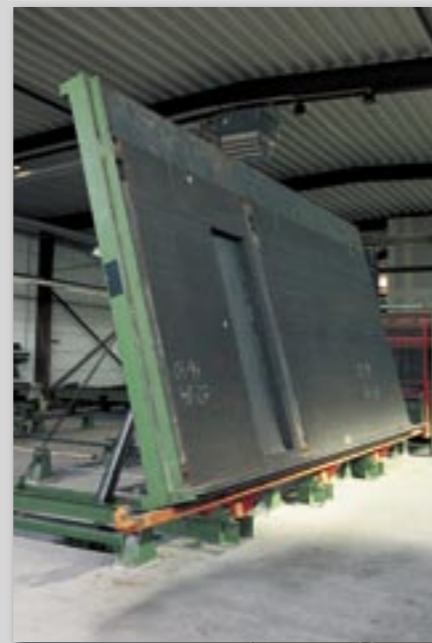
Kippstation mit Umlaufpalette.
