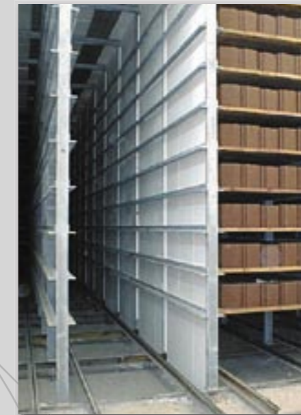
Trockenkammer in verzinkter Ausführung.
