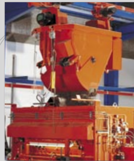
Einschieniger, absenkbarer Betonkübel mit Bodenentleerung.
