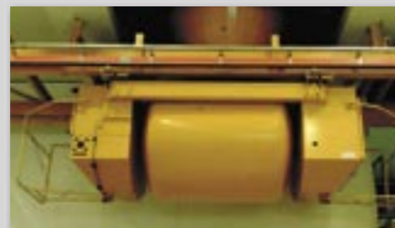
Zweischieniger Betonkübel mit Rotationsentleerung.
